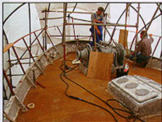
Auf dem recht nüchternen Vordeck überstand die Ankerwinde fast vollständig das Refit. Sie erhielt nur eine technische Aufwertung; Jetzt sind für die Manöver nicht mehr sechs, sondern nur noch vier Hände nötig.
