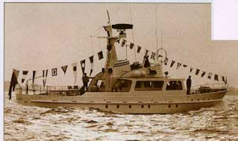
Zu Nannens Zeit (Bild unten) war der Salon eher klein; ausgelegt für vier Personen. Nun nimmt er rund 25 Passagiere auf: Die Morska-Werft verlängerte den Rumpf mittschiffs um vier Meter.
