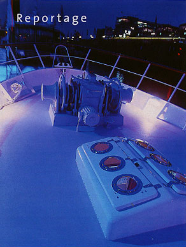
Auf dem recht nüchternen Vordeck überstand die Ankerwinde fast vollständig das Refit. Sie erhielt nur eine technische Aufwertung; Jetzt sind für die Manöver nicht mehr sechs, sondern nur noch vier Hände nötig.
